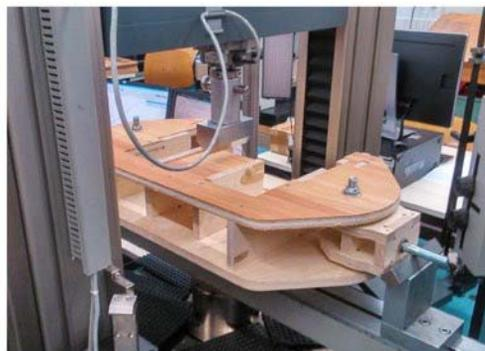
Abbildung 1 und 2: Skizze des Fahrgestells (Grafik: The FlatWorks); Bauteilprüfung (Foto: Marius Cords)
